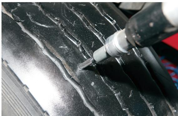
**Карбидные буры для обрезки металлокорда** применяются для удаления поврежденных тросов металлокорда. Для работы необходим высокооборотистый пневмоинструмент 18-22000 об/мин.
