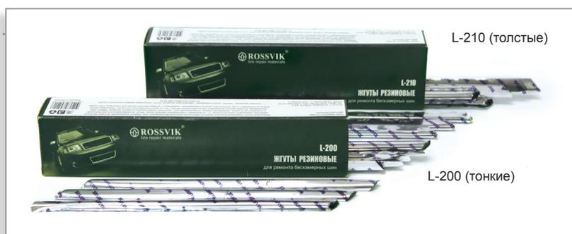
• Чтобы резиновые жгуты не рвались при установке, давление в шине следует снизить до 0,2-0,5 Атм, а для подготовки отверстия применять 6 мм спиральное шило, смазанное клеем ROSSVIK. Вращение шила следует производить в одном направлении.
