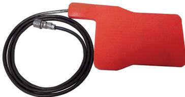
Специально для настольных вулканизаторов ТП-1М разработан эластичный нагревательный элемент 230x190 мм. С его помощью, возможно создать прогрев зоны ремонта, что особенно важно при вулканизации пробоя в беговой дорожке грузовой шины. Обеспечивает вулканизацию пластырей длиной вплоть до 230 мм.
