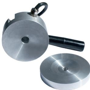
Нагревательный элемент-лекало специально сконструирован для установки вентиляей ЛК, ГК и ТК пр-ва ROSSVIK методом «горячей» вулканизации. Эта технология позволяет получить максимальную прочность связи вентиля с камерой и решить такие проблемы, как сползание вентиля и разгерметизацию в зоне ремонта.
