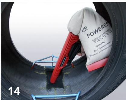
Одновременно с приклеиванием из-под пластыря выдавливается воздух. В холодное время года перед установкой пластырь желательно прогреть до 40-60 °С для повышения эластичности и клейкости. Прогрев удобно делать феном. Что касается рекомендации промазывать клеем сам пластырь, то эта мера повышает клейкость пластыря, но после такой промазки на кисть попадают химические компоненты, вызывающие самовулканизацию клея в банке.
