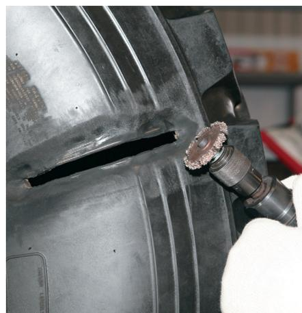
**Абразивные сферы** применяются для работы в протекторной части шин. Шар позволяет очень быстро сделать углубление правильной формы. Применяется с низкооборотистой пневмодрелью до 5000 об/мин.
