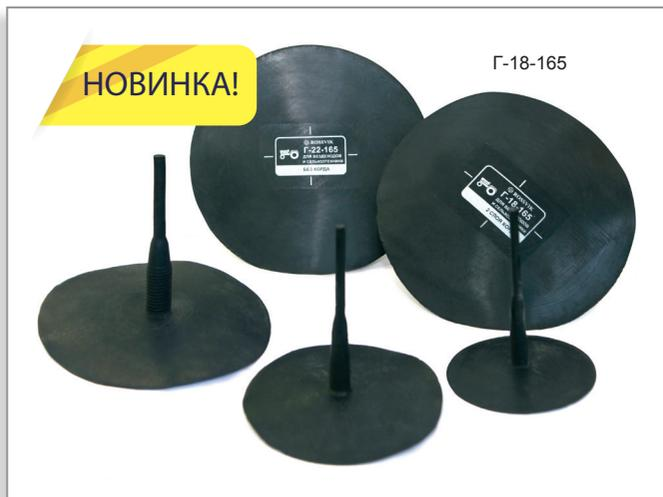
Резиновые грибки с кордовым усилением применяются для экспресс-ремонта камерных шин, эксплуатируемых при низком давлении. Ножка с резьбой надежно удерживается в канале повреждения без клея, а широкая шляпка предотвращает зажевывание камеры.
